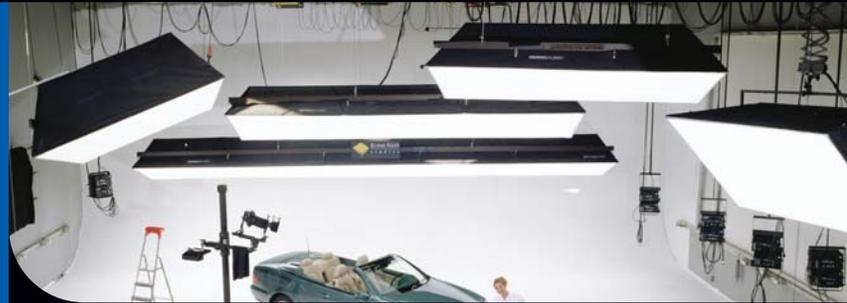
Das flexible Großlicht-Wannensystem von Hensel. Ein Grundelement hat eine Dimension von 1,3 x 2 m und benötigt einen Stabblitz. Durch entsprechende Verlängerungen sind praktisch alle Größen realisierbar. Bei einem Autolight können weitere Elemente immer in der Länge angesetzt werden, beim Megalight in der Breite. Die hohe Leistungsausbeute und die sehr gleichmäßige Ausleuchtung sind ihre hervorragendsten Merkmale.
